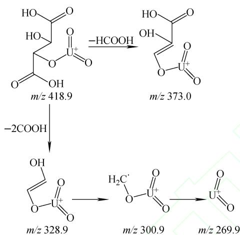
图 4  $[\text{UO}_2\text{HTar}]^+$  质谱裂解途径Fig. 4 MS fragmentation pathways of  $[\text{UO}_2\text{HTar}]^+$
