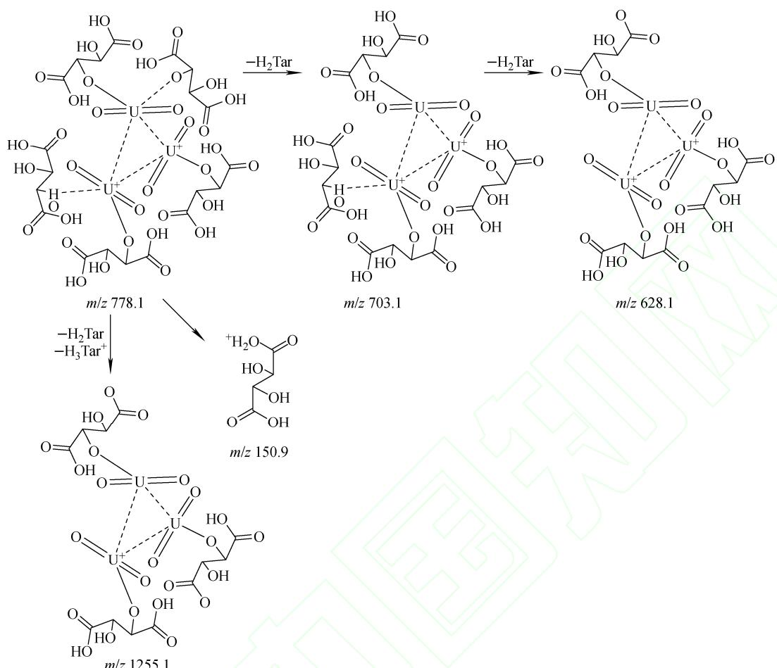
图 10  $[(\text{UO}_2)_3 \text{Tar}(\text{HTar})_2 (\text{H}_2\text{Tar})_2]^{2+}$  的质谱裂解途径
