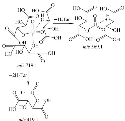
图 8  $[\text{UO}_2\text{HTar}(\text{H}_2\text{Tar})_2]^+$  的质谱裂解途径Fig. 8 MS spectral fragmentation pathways
