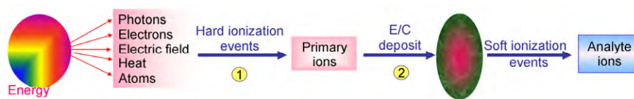
图3 复杂基体样品能荷传递的基本过程和关键步骤
